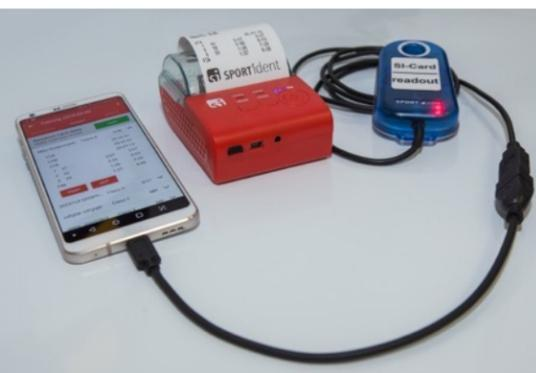
1 kit SI orienteering App. Permet la lecture autonome en forêt sans alimentation des puces avec une application android et l'impression des tickets de résultat sur imprimante thermique:
